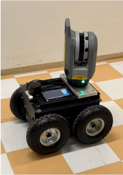
Kuva: Trimble X7 skanneri robotin päällä
