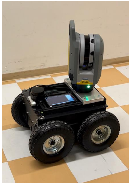
Kuva 4: Mobiilirobotti (Roverpro), jossa Trimble X7
