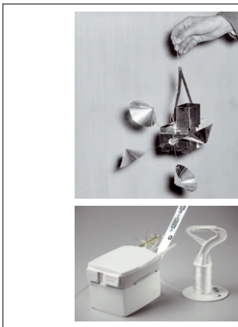
Radiosondi 1930-luvulla ja 2010-luvulla. (Kuvat: © Vaisala Oyj)
