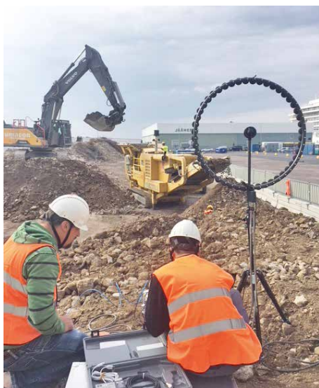
Kuva 10 Akustisen kameran mittaustöitä, kauhakuormaaja ja mobiilimurskain (kuva: Satu Hermunen)
